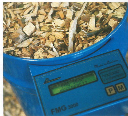
Feuchtemessung – eine gute Trocknung des Hackgutes ist entscheidend für die Qualität. Foto: GESA, Wuppertal
